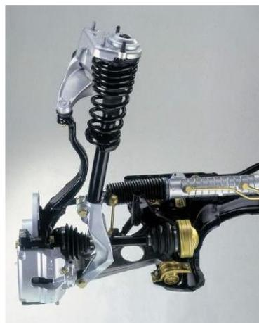
Gli ammortizzatori a controllo elettronico modificano il loro effetto di smorzamento e l'assetto in base ad impulsi elettrici provenienti da un sistema di controllo che analizza i segnali, provenienti da appositi sensori, sull'entità della sterzata, della frenata, dell'accelerazione e delle oscillazioni della carrozzeria. Si tratta quindi di un controllo dinamico dell'assetto.
